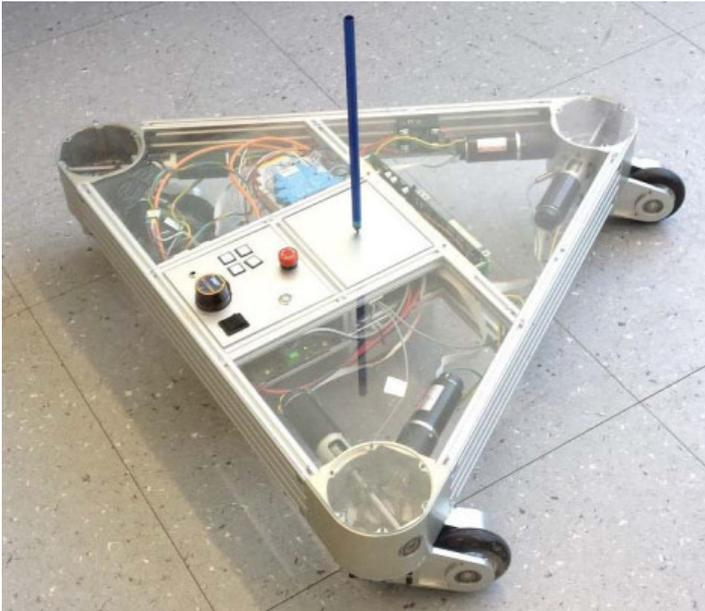
Abbildung 1: OmniMoBot balanciert inverses Pendel
